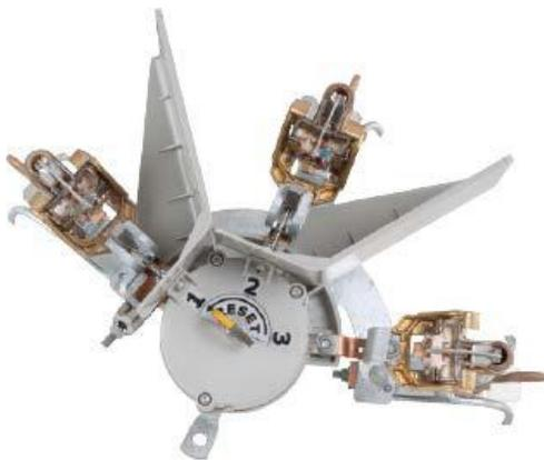
El anillo de reposicionamiento de operación por pértiga en la base del cortacircuito carga el mecanismo de energía almacenada...lo cual también da la indicación de que hay un fusible activo. Para reconfigurar el mecanismo, se debe insertar una punta de pértiga por el anillo de reposicionamiento y después es necesario girar el mecanismo en el sentido contrario a las manecillas del reloj.
