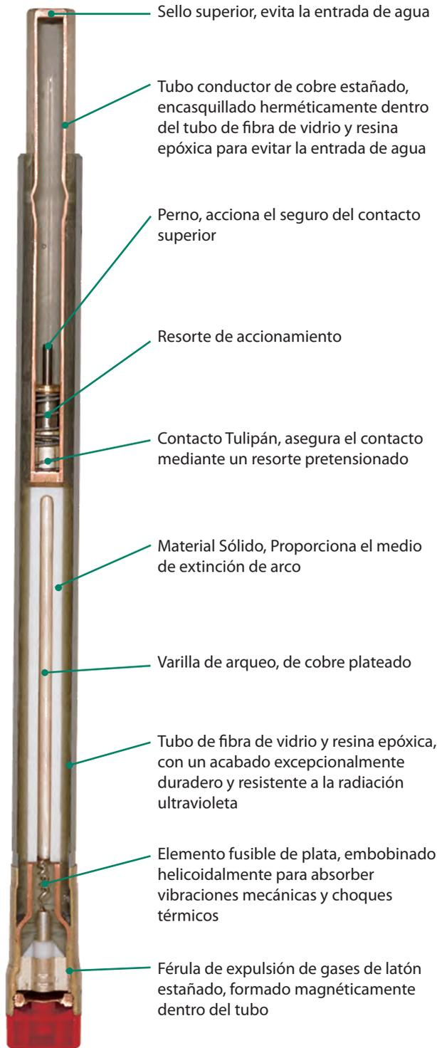
Los Fusibles de Potencia SMD-20 emplean una tecnología única de material sólido y baja energía para la interrupción de fallas que produce una expulsión mínima de gases y sólo un 20 por ciento de la energía del arco de un cortacircuito convencional.
